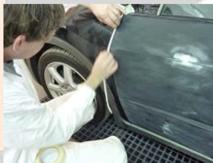
2. Поставете лентата в процепите, като вмъкнете м/у детайлите по-тясната страна. Нагласете лентата така, че тънката част да е отвътре, а дебелата - отвън
