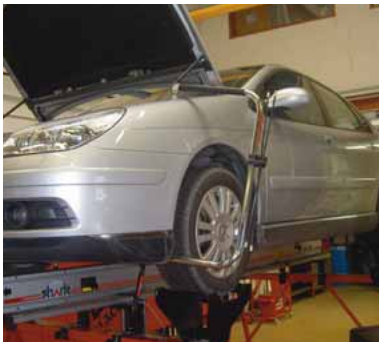
Measuring of high test point (Mc Pherson) Contrôle point haut (Mc Pherson) Abgreifen von Messpunkten in oberen Bereich der Karosserie (z.B. Federbeindom, Dachtraverse) Meten van hoog testpunt (Mc Pherson)
