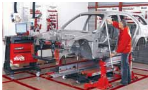
Shark measuring gauge for high test points Pige de mesure Shark pour points de contrôle élevés Oberbau-Messstab für das elektronische Messsystem Shark Shark meetinstrument voor hoge testpunten
