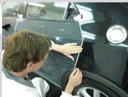
3. Проверете, за да се уверите, че лентата плътно ляга във всички процепи
