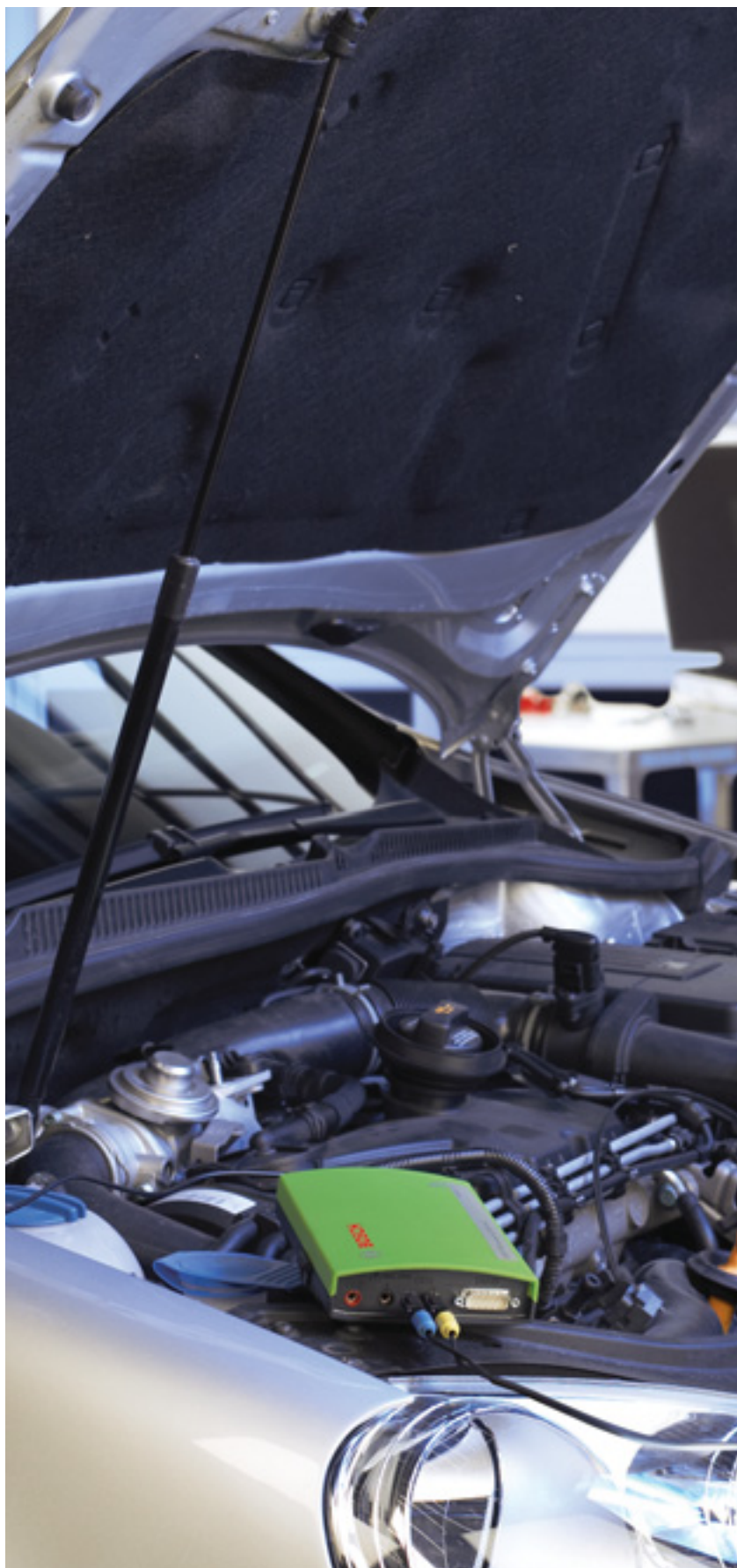
Диагностика на управляващи блокове и безжичен пренос на извлечените данни с обсег до 100 м
