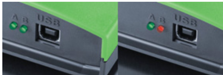
Индикация на състоянието с помощта на LED върху корпуса на KTS
