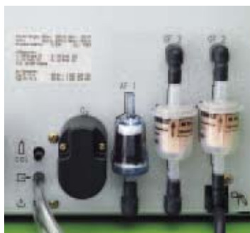
Бърза поддръжка: лесно достъпни филтри на задната страна на уреда
